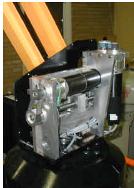
MAC141 motoren med påbygget bremse
