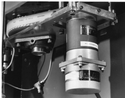
Rundborddrevet med stepmotor og gear.
