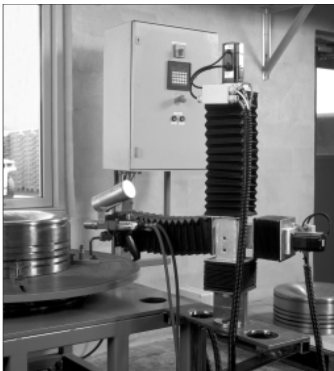
Forsøgsopstillingen til pulverflammesprøjtning i sporene i 50cm stempelkrone.
