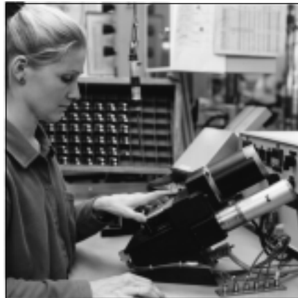
Arbejdspladsen til for-indstilling af pressostater/termostater.
