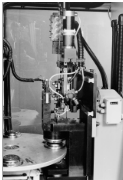
Den ene af maskinerne der afklipper og sætter kobberstavene ned i rotorelementet på den anden maskine.
