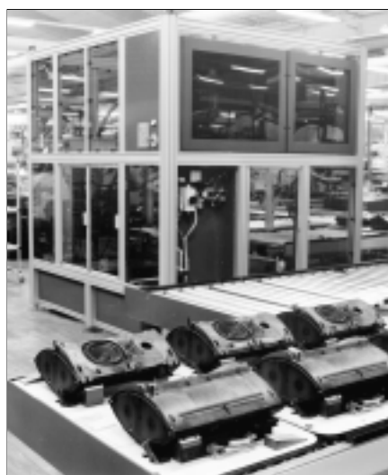
Skruetrækker-robotten hos Bang & Olufsen
