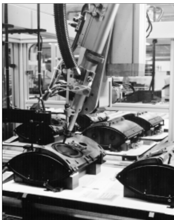
Skruetrækkeren ved isætning af skruer i højttalerkabinettet
