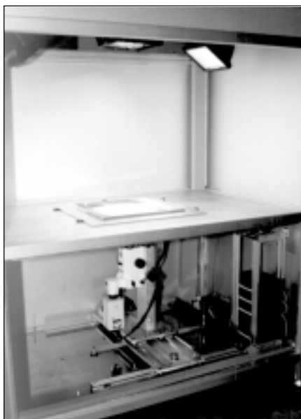
Det komplette "Dirtec" system til driftskvalitetskontrol af urenheder i plasticpulver. Plasticpulveret er placeret i skålen på bordet. X-Y bordet med kamera etc. og JVL styringerne ses nedenunder.
