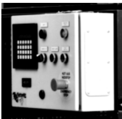
JVL Keyboard/Display modul monteret i lågen i et styrings-skab
