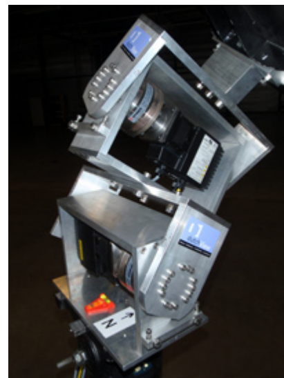
Montering af motorerne i enheden
