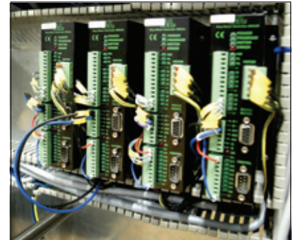
Stepmotorstyringerne SMC35 i styreskabet.
