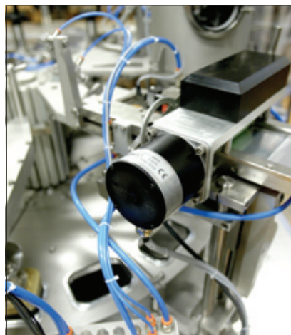
En af stepmotorerne i fylde- og pakkedelen af maskinen.
